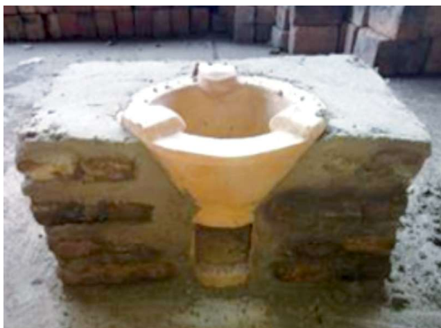
Foyer amélioré encastré dans une maçonnerie en briques cuites pour améliorer sa durabilité et sa maniabilité
